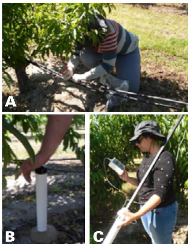
**Figura 4.** Ação Rega deficitária controlada. A-Ajuste de tubagens correspondente às modalidades; B – Colocação dos tubos para leitura da humidade do solo utilizando a sonda Diviner; C – Avaliação da humidade do solo com sonda Diviner.
