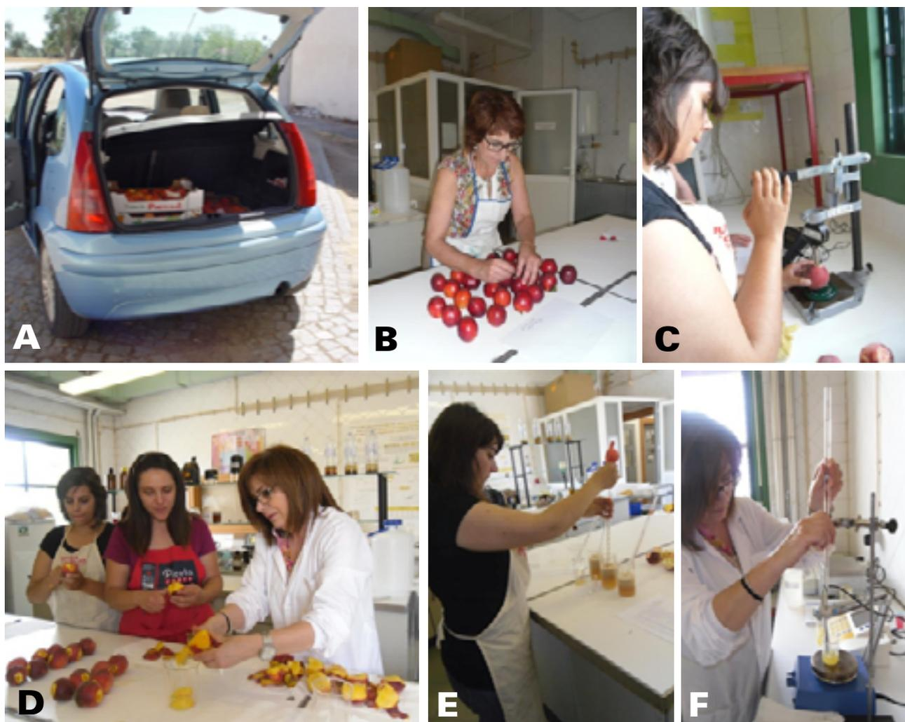
**Figura 6.** Ação Caracterização dos frutos; A – Chegada das amostras; B – Identificação dos frutos; C – Avaliação da dureza; D – Preparação da amostra para fazer sumo; E – Preparação de três subamostras de sumo e F – Determinação da acidez.
